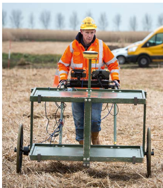
Non-realtime actieve oppervlakedetectie voor de aanleg van Schiphol Trade Park in Hoofddorp (foto: Heijmans Explosieven Opsporing).
